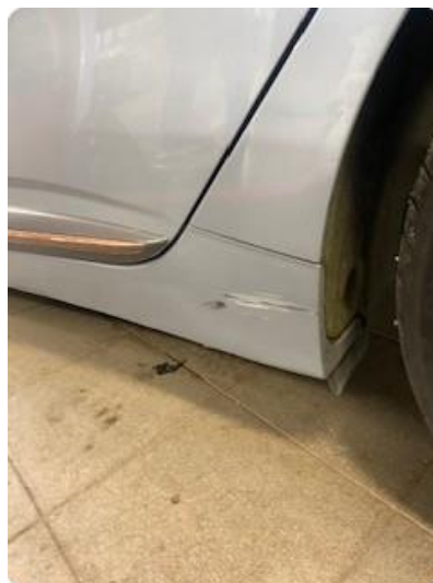
1.2 Ripe(r) ned til grunning
